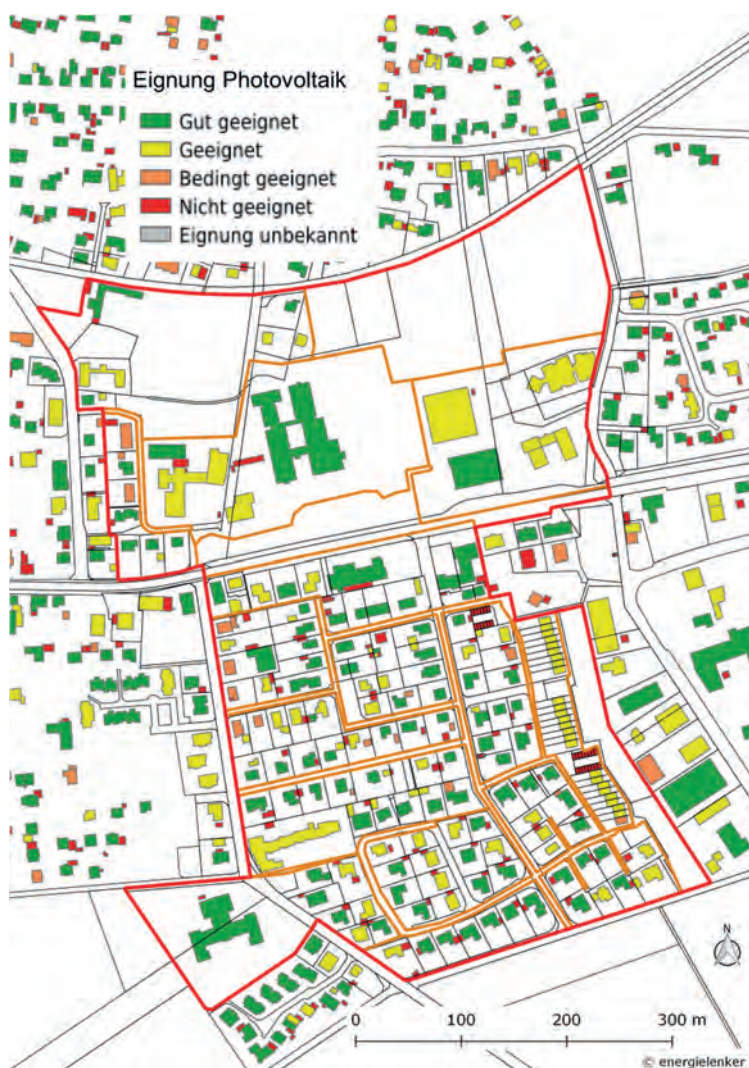
Abbildung 31: Ausschnitt aus dem Solarkataster des Kreises Steinfurt – Eignung für PV-Anlagen (Quelle: Kreis Steinfurt 2018 15 )
